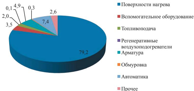
Рис. 1.6. Распределение отказов котельного оборудования, %
