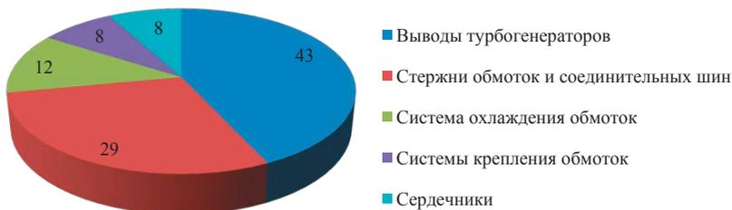
**Рис. 1.28.** Распределение причин отказов статоров турбогенераторов, %
