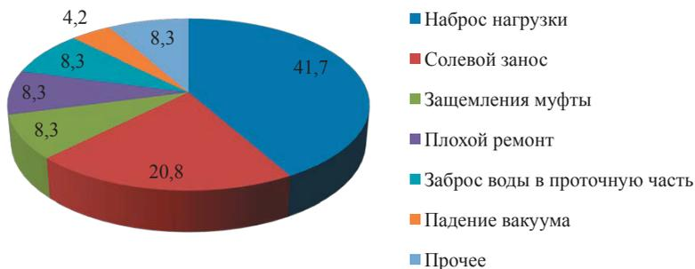
**Рис. 1.21.** Распределение причин увеличения осевых усилий, %
