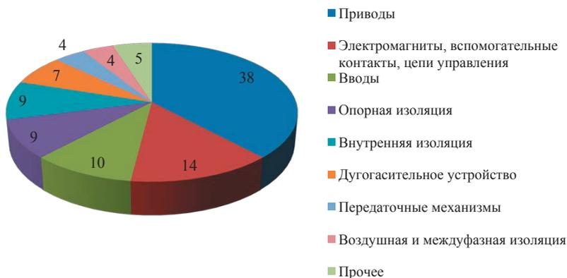
**Рис. 1.32.** Распределение причин отказов масляных выключателей, %
