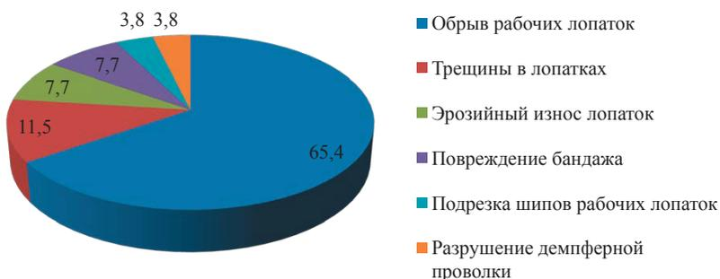
**Рис. 1.12.** Распределение причин повреждений рабочих лопаток турбин, %
