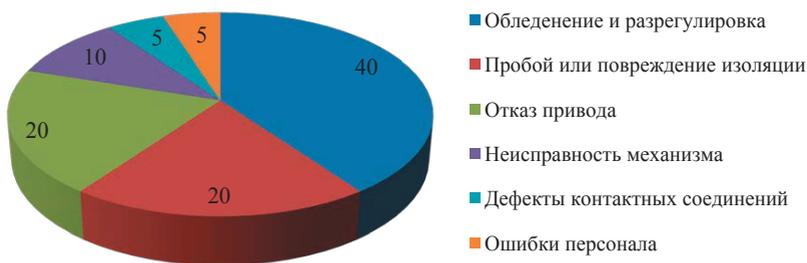
**Рис. 1.34.** Распределение причин отказов разъединителей, %
