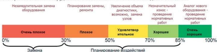
**Рис. 6.11.** Пример карты технического состояния в формате интегральной оценки
