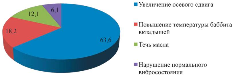
Рис. 1.19. Признаки, наблюдаемые при повреждении упорных подшипников, %
