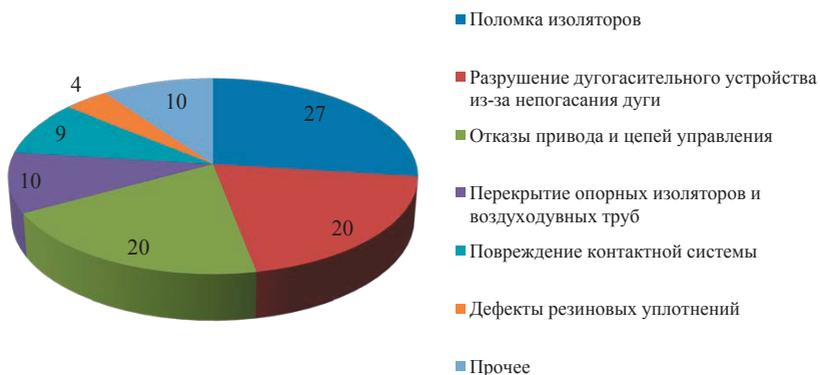
**Рис. 1.33.** Распределение причин отказов воздушных выключателей, %
