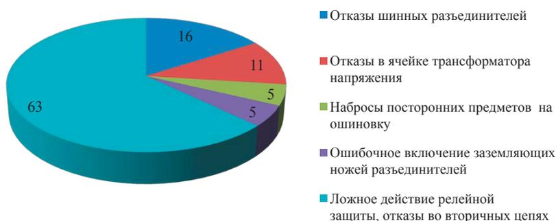
**Рис. 1.36.** Распределение причин аварийного отключения рабочих систем сборных шин напряжением 500 кВ, %
