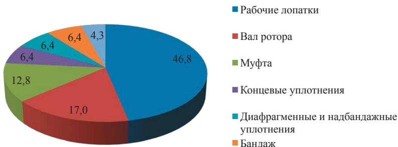
**Рис. 1.11.** Распределение интенсивности отказов элементов ротора, %
