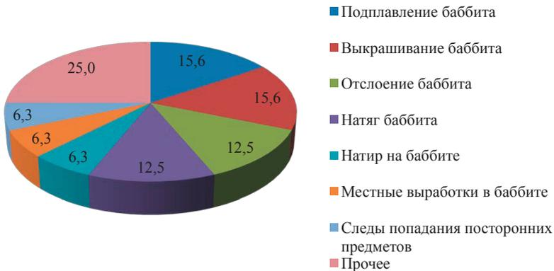
**Рис. 1.16.** Распределение причин повреждений опорных подшипников, %
