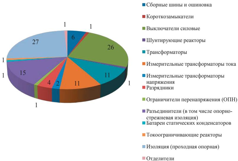
**Рис. 1.25.** Распределение по видам оборудования количества технологических нарушений (прямых и косвенных) оборудования класса напряжения 6–500 кВ ПС в ОЭС СВ, %
