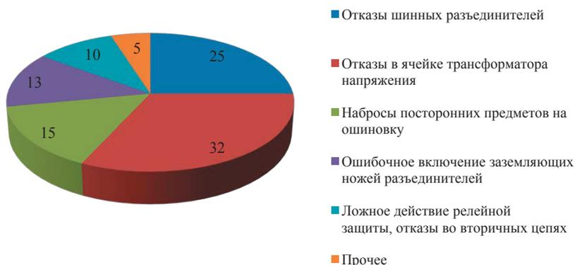
**Рис. 1.35.** Распределение причин аварийного отключения рабочих систем сборных шин напряжением 220 кВ, %
