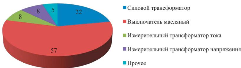
**Рис. 1.27.** Распределение технологических нарушений маслонаполненного оборудования, %
