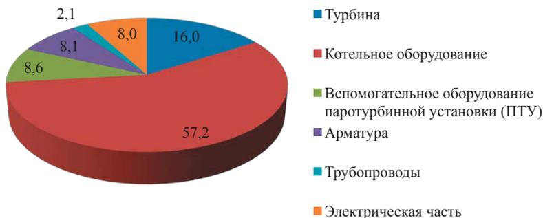
**Рис. 1.4.** Распределение отказов оборудования ТЭС по видам оборудования, %
