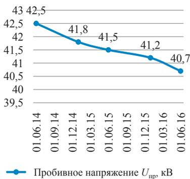
**Рис. 4.9.** Абсолютное значение изменения пробивного напряжения
